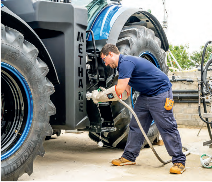
Schwere Landmaschinen eignen sich kaum für eine Elektrifizierung: Der Schlüssel zu CO2-Einsparungen liegt in alternativen Kraftstoffen wie Gas, Biodiesel und Sprit aus Rest- und Abfallstoffen. Das Bild zeigt den Prototyp eines Flüssiggas-Schleppers von New Holland.
